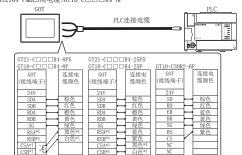
GT2104-PMBD用电缆没有向信号名(RSA、RSB、CSA、CSB)的连接。 连接某些PLC时需要自制电缆。 详情请参考GOT2000系列连接手册
